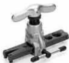
Flangitubo eccentrica con frizione, indispensabile per ottenere cartelle simmetriche e corrette. Universale per tubi da 1/4" - 5/16" - 3/8" - 1/2" - 5/8" - 3/4"
